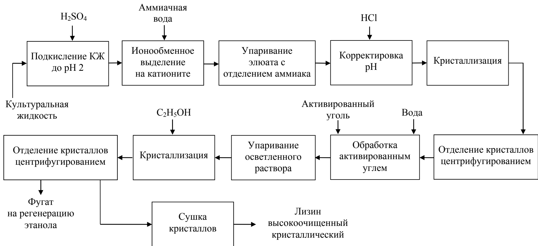
Рис. 1.5. Схема получения высокоочищенного кристаллического лизина
